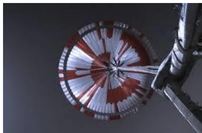
パーサピアランスの着陸時に開いたパラシュート。赤と白の模様が暗号になっていた=NASA 提供
